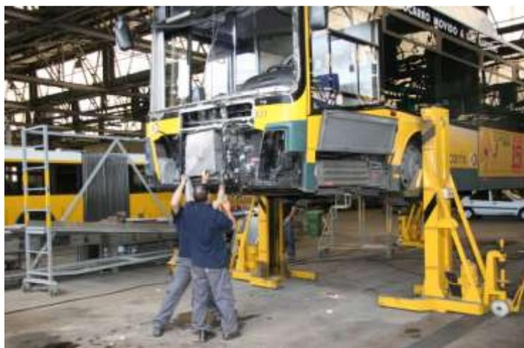
Nas Estações de Miraflores e da Pontinha, a Hydraplan (Concessionário MAN) continuou a assegurar a manutenção de 148 autocarros “standard” MAN 18.310 HOCL.
