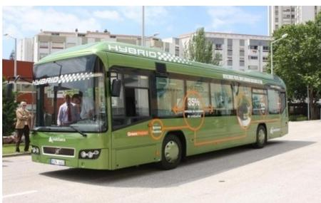
O autocarro "Volvo 7700 Hybrid ", objecto de experimentação, apresenta uma inovadora solução em "paralelo", que permite operar só em modo eléctrico, só em modo Diesel, ou em simultâneo.
